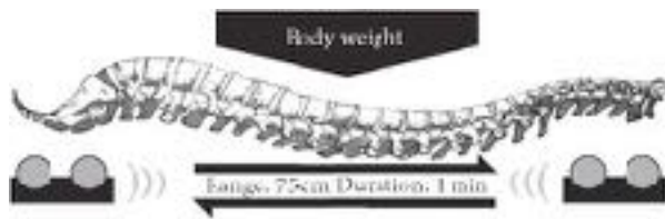
Rycina 2: Schemat automatycznego urządzenia do masażu chiropraktycznego. Para rolek masuje mięśnie wzdłuż kręgosłupa poruszając się w górę i w dół od odcinka szyjnego do kręgów guzicznych.
